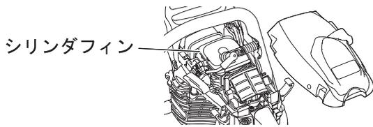
シリンダフィンにゴミが詰まるとエンジンの冷却効果が悪くなります。シリンダフィンの間のゴミやホコリを取り除いて冷却風の通りを良くしてください。
