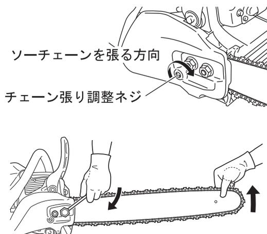
1. ガイドバーの先端を持ち上げ、チェーン張り調整ネジを矢印の方向に回し、ソーチェーンがバー下側に接触する程度に調整してください。
