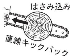
はさみ込み      ガイドバーの上側での切断
