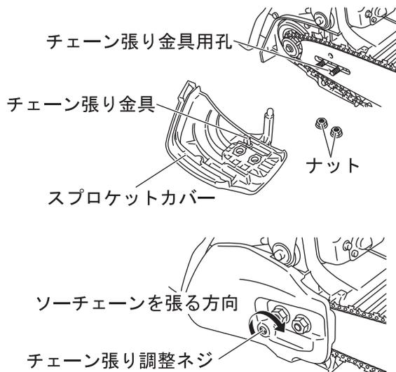
5. チェーン張り金具をガイドバーの孔に入れて、スプロケットカバーを取り付けてください。
