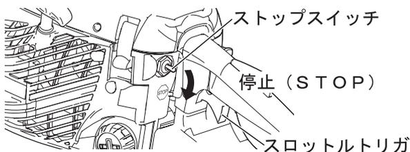
スロットルトリガから指を離し、ストップスイッチを停止 (STOP) 位置にしてください。
