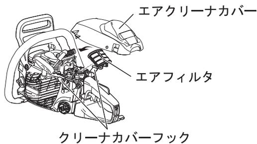
1. チョークノブを引いてから、フロントハンドガードを前方に倒して、両側のクリーナカバーフックを引いてエアクリーナカバーを外し、エアフィルタを左方向に回して取り外してください。
