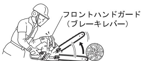
チェーンブレーキは、フロントハンドガード（ブレーキレバー）が前方に押されること、または製品が一定以上の衝撃を受けることにより作動します。チェーンブレーキは、フロントハンドガードを手前に引くことにより解除されます。
