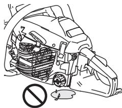
燃料を補給した後、燃料タンクキャップを確実に締め付け、燃料パイプ、燃料系グロメット、燃料タンクキャップ周辺から燃料の漏れ、にじみがないことを確認してください。
