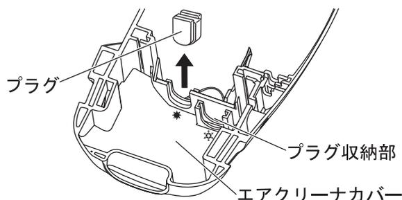
寒冷時に使用する際、キャブレタ（気化器）の不調を防止するため下記の操作をしてください。
