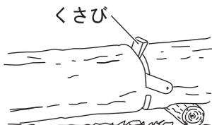
ソーチェーンが木材にはさまりチェーンソーが抜けなくなった場合は、直ちにエンジンを停止して切り口にくさびを押し込んで開き、チェーンソーを引き出してください。
