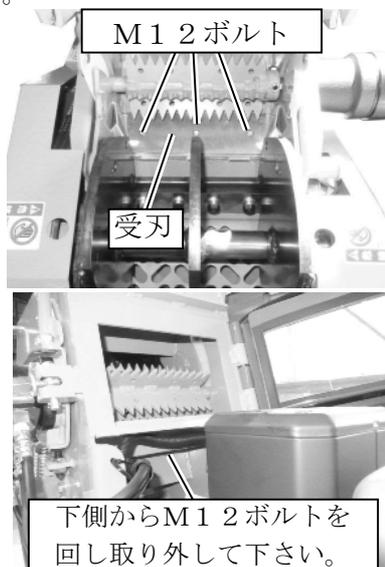
6. 受刃を反転、または交換しM12の受刃固定ボルト（3本）を軽く締めます。（受刃台座が長穴になっております）
