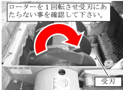
2. チップナイフの反転、または交換、調整後は、ロータロックピンとロータカバー、投入口のホッパを元に戻し、固定ネジをしっかりと締め付けてください。
