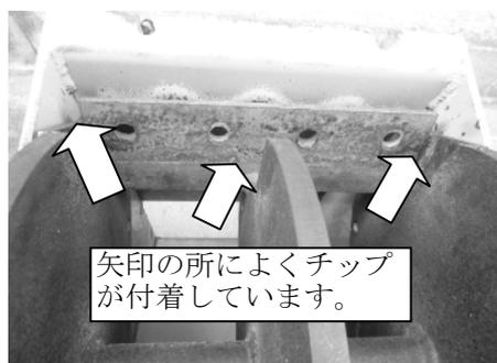
7. チップナイフを取り外した状態で、ロータのナイフ台座と受刃の隙間調整をして下さい。P 29『受刃の反転・交換・調整』の要領で行って下さい。
