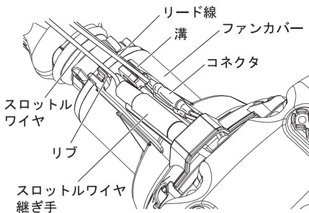
7. スロットルワイヤ継ぎ手とコネクタをファンカバーに納め、スロットルワイヤはリブに這わせ、リード線は溝に納めてください。
