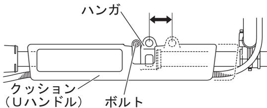
ハンガのスクリュ（ボルト）をゆるめ、ハンガを前後に移動して、刃と飛散防護カバーが地面と水平になるように調整し固定してください。
