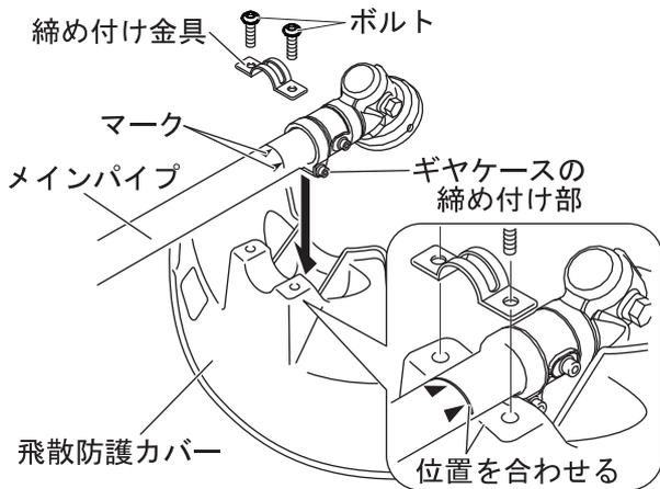
1. ギヤケースの締め付け部を飛散防護カバー上部のヘコミに、締め付け金具をマークの位置に合わせてください。
