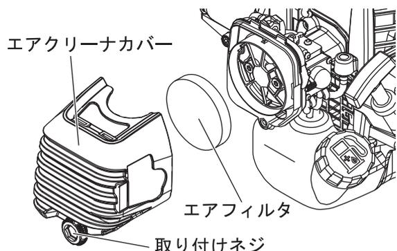
1. チョークレバーを「閉」の位置にしてから、取り付けネジをゆるめ、エアクリーナカバーを外してください。
