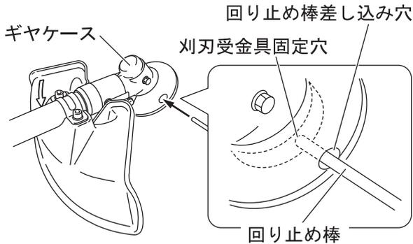
3. 刈刃用ボルトを回して、ギヤケースの回り止め棒差し込み穴と刈刃受金具固定穴を合わせ、付属の回り止め棒を差し込み、刈刃受金具を固定してください。
