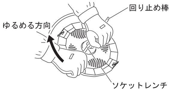
1. 刃を回して回り止め棒差し込み穴と刃受金具固定穴を合わせ、付属の回り止め棒を差し込んでください。
