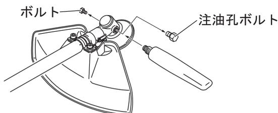
1. 注油孔ボルト、ボルトを外してください。
