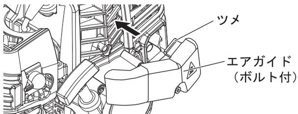
2. エアガイドのツメをシリンダカバーに合わせ、付属のレンチで取り付けてください。(エンジン後方から温かい空気が気化器室に入ります)
