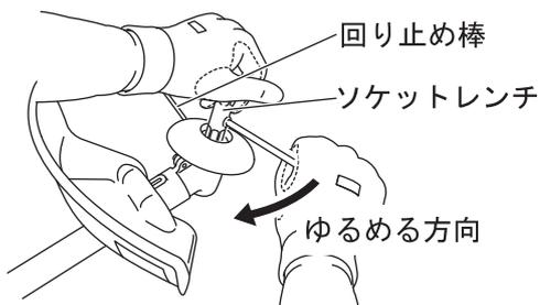
4. ギヤケースを反転して、付属のソケットレンチで刈刃用ボルトを時計方向に回してゆるめて、刈刃用ボルト、刈刃押さえ金具を外してください。
