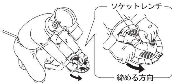
6. 刈刃押さえ金具を取り付け、刈刃用ボルトを手で仮締めしてください。
