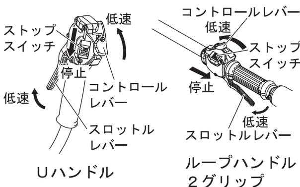
1. スロットルレバーから指を離して、コントロールレバーを低速の位置にしてください。エンジンがアイドルリング（低速運転）状態になります。
