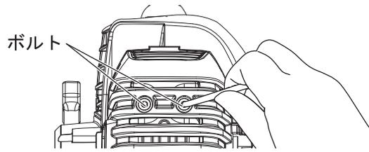
1. マフラの締め付けボルトにゆるみがないか確認してください。ゆるみがある場合は、付属のトルクスレンチで増し締めしてください。
