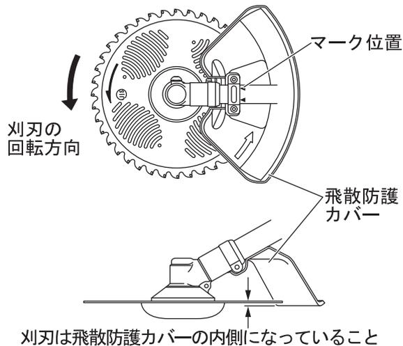
8. 回り止め棒と刃カバーを外し、刃を手で回して振れ・ゆるみがないか確認してください。
