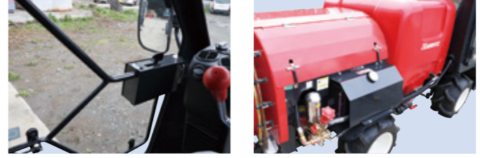
サイド・足元には大型窓を装備 視界良好で、作業時・移動時の確認もしっかり行えます。 耐薬性能を考慮した薬液タンク 耐薬性能を考慮したポリエチレン素材を採用し、さらに配管やポンプもメンテナンス性に配慮したレイアウトです。
