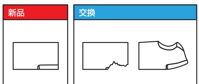
ナイフにヒビ、割れ、摩耗が無いか点検をしてください。交換の際には必ず純正部品を使用してください。
