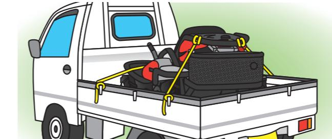
駐車ブレーキをかけて、製品は十分に強度のあるロープで確実に固定してください。
