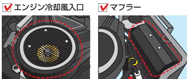
エンジン吸排気系統に草屑等が堆積したまま作業を続けると、オーバーヒートの原因となるばかりでなく、エンジン温度の上昇により、火災の原因となります。
