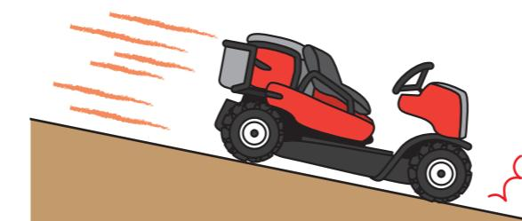
坂道を下るときは十分に速度を落とし、変速レバー・クラッチレバー類の不要な操作は行わないでください。
