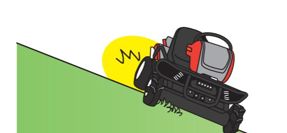
傾斜地では等高線方向で作業してください。作業傾斜角度を超える使用は本機が横転して機械の下敷きになる恐れがあり、大変危険です。
