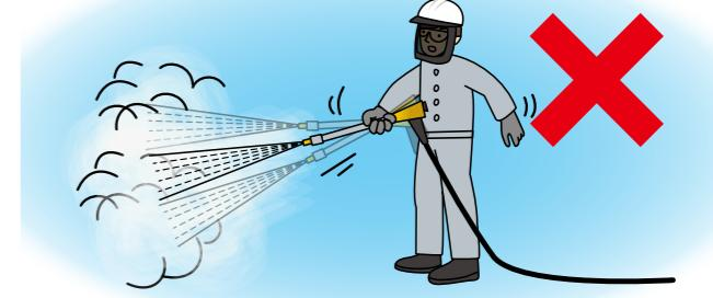
噴射開閉時は反動がありますので、足元を安定させ、噴射ガンは前後のグリップを両手で持って作業を行ってください。噴射時に片手で持つのは危険です。
