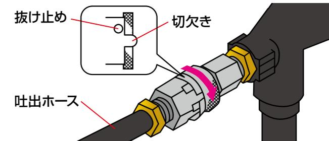
吐出ホースは確実に接続して下さい。抜け止め機構がある場合は、確実にロックされていることを確認してください。
