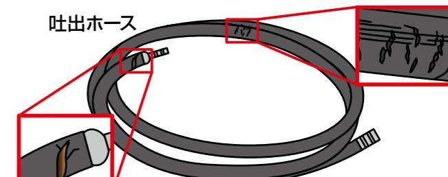
ホースやノズルのヒビ割れ・亀裂・摩耗・硬化・水漏れが認められた時は、直ちに新品に交換してください。
