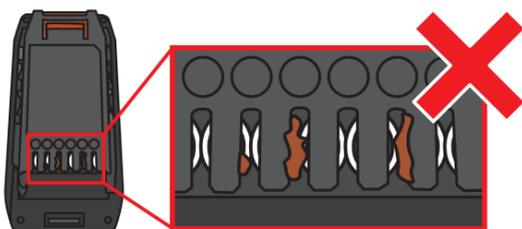
端子の腐食したバッテリーは、ショート・導通不良などにより破裂、発火などの原因になります。
