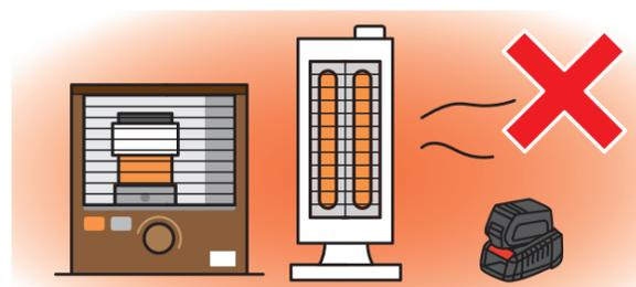
ストーブのそばなど、高温になる場所で充電しないでください。液漏れ、破裂、発火の原因になります。
