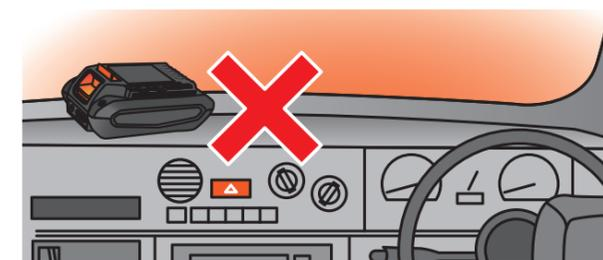
窓際などの直射日光の当たる場所、ストーブのそば、自動車の車内など高温になる場所に放置しないでください。液漏れ、破裂、発火の原因になります。
