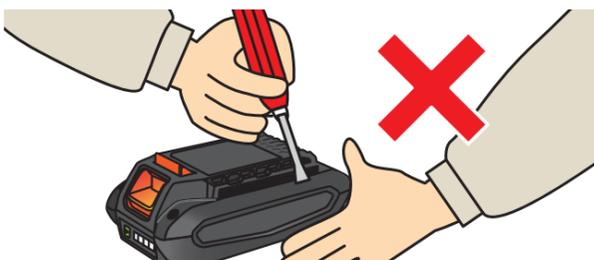
分解するとやけどを負ったり、破裂し発火する場合があります。また改造により保護回路が損なわれ、破裂、発火の原因となります。
