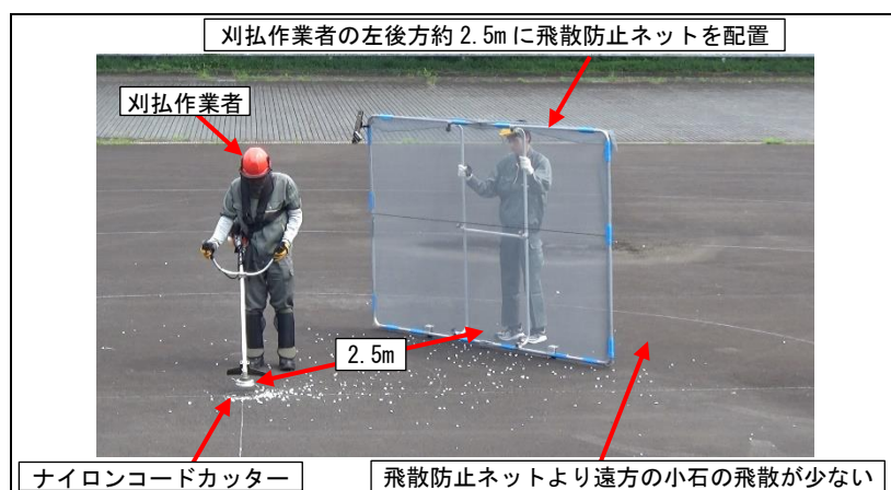
写真 16. 飛散防止ネットによりナイロンコードカッターでの小石の飛散範囲が縮小した例
