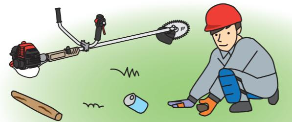
作業中に刈刃が石や空き缶などの障害物に接触すると、思いがけない方向に飛び跳ねることがあります。
