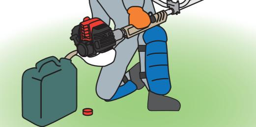
長期間使用しない時は、燃料タンク・気化器内部の燃料を抜いてください。燃料が変質し不具合の原因となります。
