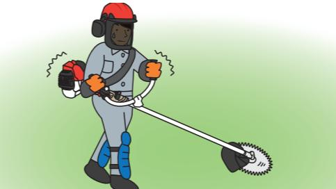
長時間連続での作業は控え、身体に不調を感じたらすぐに使用をやめてください。※使用時間は振動の大きさによって規制されています。
