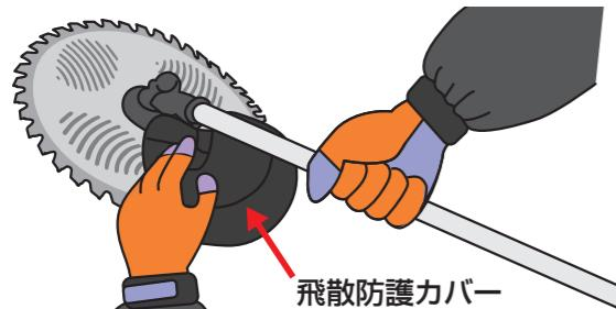
飛散防護カバーは作業者の方へ異物が飛んでくるのを防ぎます。外して使用すると事故を招く恐れがあります。
