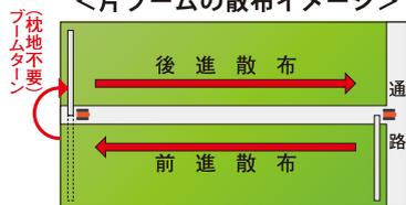
●片ブーム180° ターン方式なので旋回のための枕地が不要。往復作業が効率良く行えます。
