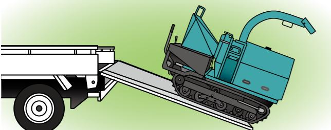
トラックへの載せ降ろしは、取扱説明書を確認し、必ずゆっくりとした速度で、正しい方法に従って安全に実施してください。
