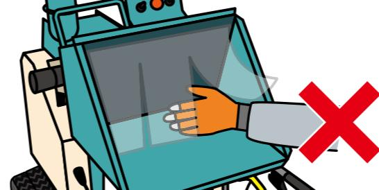
作業中は投入口付近（チップガードや警告ラベル）より奥に絶対に手を入れないでください。短材を投入する場合は棒等で押し込むようにしてください。
