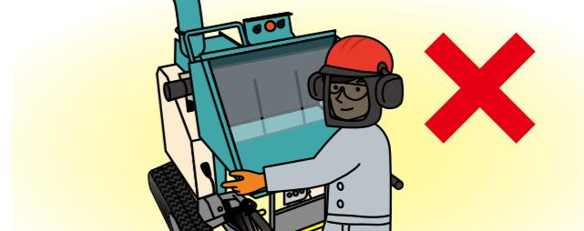
粉碎物を投入した際に、材料が暴れたり、投入口から破片が飛び出してくれる場合があります。投入口の正面に立つのを避けて作業を行ってください。
