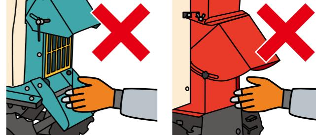
排出口から絶対に手をいれないでください。ナイフはエンジン停止後も惰性で回転している為、点検は回転部が完全に停止したことを確認後、行ってください。
