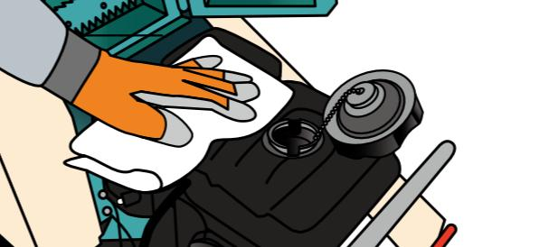
給油はエンジンが十分に冷えてから行ってください。給油中にこぼれた燃料は必ずふき取ります。また、燃料ホース等に漏れがないか点検をしてください。
