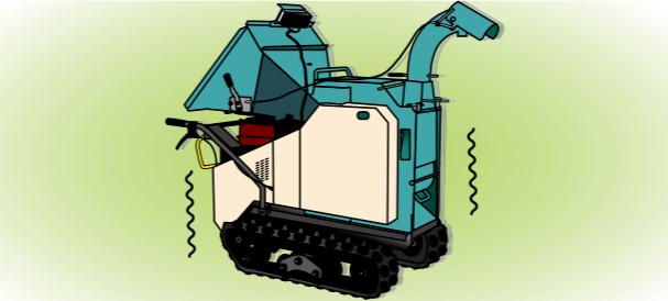
異音がしたり、異常を感じたら作業を中止し、エンジンを切って回転部の停止を確認してから点検をしてください。
